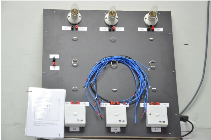
Rajah 4 : Set lengkap Model Litar Lampu
